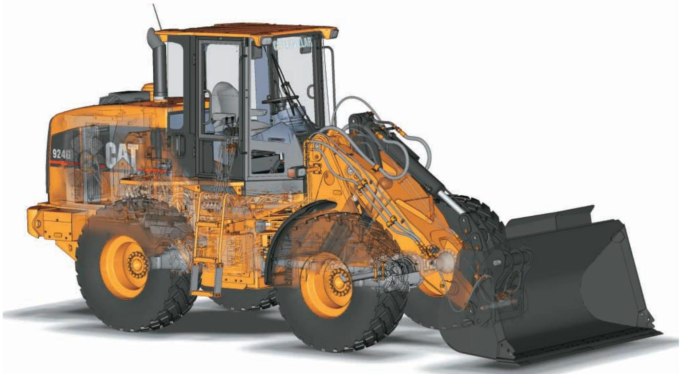
**Motor Caterpillar.** El Motor 3056E de seis cilindros, con Inyección Directa y Turbocompresión (DIT) y con posenfriador de aire a aire (ATAAC), tiene una reputación probada, gracias a su fiabilidad, durabilidad y rendimiento. La inyección del combustible se controla electrónicamente para permitir una sincronización precisa de la inyección.
